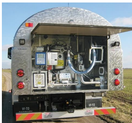
Sistema de dosificación para camión cisterna
