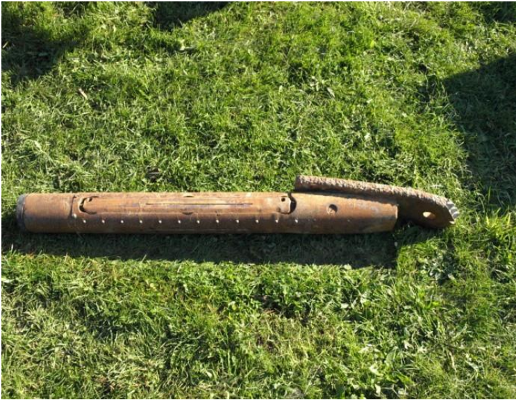
Typisk anvendt borehoved med skråtstillet front.
