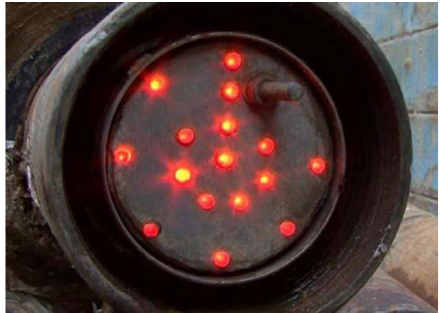
Optisk lysgiver, også kaldet målskiven, monteret bag borehovedet
