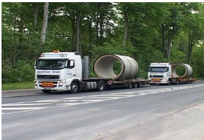
Betonrør ankommer til byggepladsen et ad gangen
