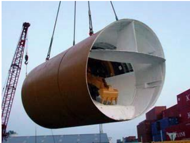
Rørfront med manuel betjent hydraulisk gravearm
