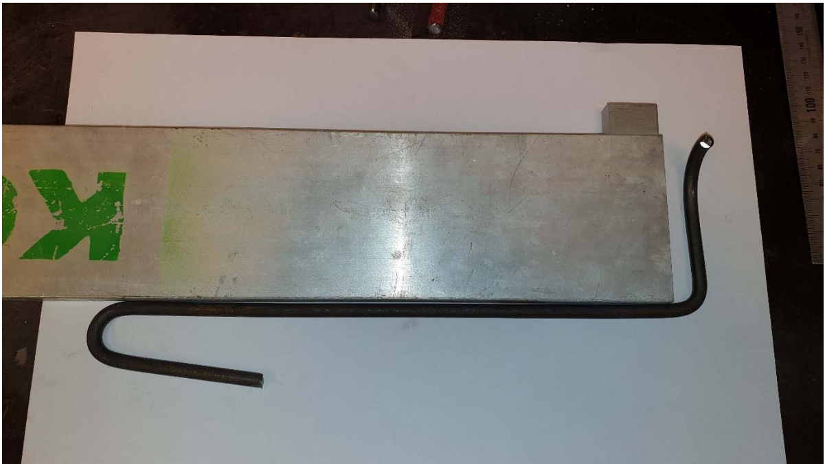
Figur 9-4 Illustration af krumningsmåling af rundjern.
