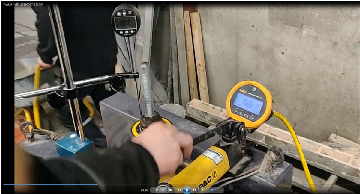
Figur 9-2 Illustration af belastning og dataopsamling via video.
